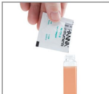
ガラスセルを取出しその水に試薬を加えます。
