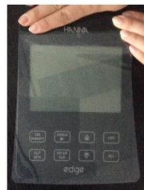
5. 上部が貼られた状態で保護フィルムの下側を持ち上げ、先ほどはさみで切った部分からノッチを持ち、セパレーターを剥がしていきます。この時上側にある保護フィルムをゆっくりと貼り合わせていきます。本体とフィルムの間にある気泡を押し出して取り除けば終了です。
