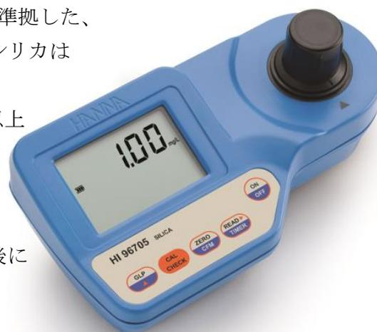
HI 96705 は測定範囲が **0.00~2.00mg/L**、精度は $\pm 0.03\text{mg/L}$   $\pm$ 測定値の 3%と高い精度を持っています。
