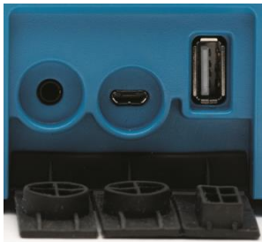
左：pH電極用 中央：電源接続およびPC接続用 右：USBメモリー用
