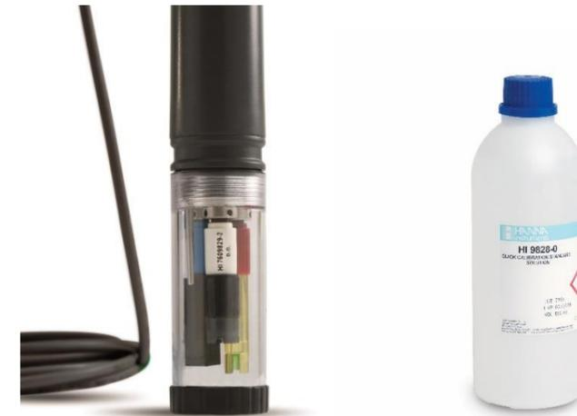
簡易標準液は校正用ビーカーに入れ電極にセットし使用します
