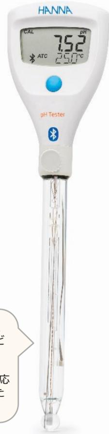
±0.02の精度と5点校正という卓上型に匹敵するほどの高精度タイプ。内部液の補充も可能。強酸/強塩基の測定にも対応できる、今までになかったラボ向けのpHテスター。
