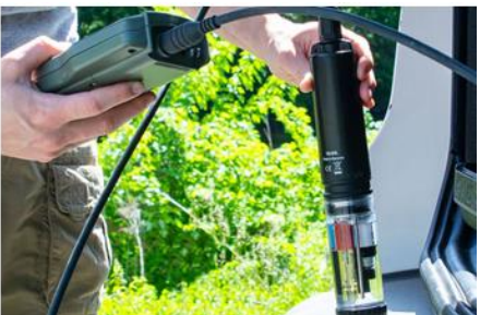
専用の標準液でpH/EC/DOの校正を一度に行えとっても便利
