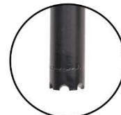
温度センサー内蔵ポーラログラフ式デジタル電極は長さ120mm、直径12mm。細径のため便利で多用途です。ボディ材質はPEI。
