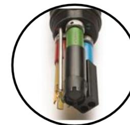
電極先端部には交換可能なpH/ORP(pH)センサー、DOセンサー、ECセンサーを取り付けて測定します。
