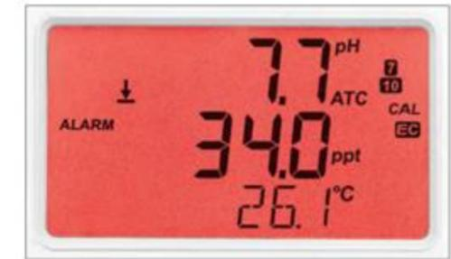
pH、塩分、温度は同時に表示しバックライト付きなので暗い場所でもはっきりと読み取れます。
