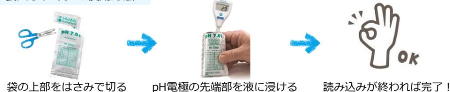
袋の上部をはさみで切る      pH電極の先端部を液に浸ける      読み込みが終われば完了！
