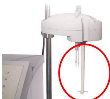
滴定方法ではサンプルを攪拌しないと滴定液がしっかりと混ざりあわず、数値のブレが多くなります。マグネチックの攪拌子だと、測定後に毎回ビーカーのマグネットを取り出す手間がありました。HI 901Wのスターラーはスクリーが回転する為、面倒な取り出し作業がなく簡単です！
