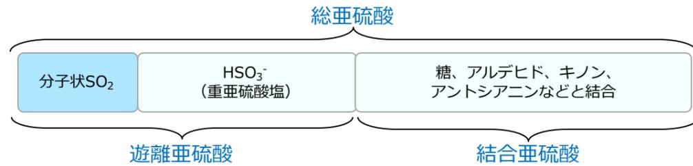
糖などと結合したものが**結合亜硫酸**、結合せずに残ったものが**遊離亜硫酸**。2つを合わせて**総亜硫酸**と呼びます。遊離と結合亜硫酸の割合はワインごとに異なりますが、この中で注目すべきは遊離亜硫酸のうち、分子状SO<sub>2</sub>。バクテリアや野生酵母の増殖を抑え、酸化防止に有効なのは主に分子状SO<sub>2</sub>です。そして分子状SO<sub>2</sub>の量はそのワインのpHに依存します。
