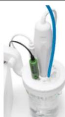
電極ホルダーには電極3本、チューブ4本、温度センサー1本をセットできます。取り外し可能なスターラー、調節可能なアームによりコンパクト設計でありながら操作性に優れています。
