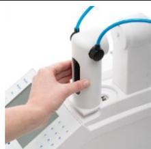
ハンナ独自のビュレットシステムにより滴定剤と試薬の交換は数秒で行えます。通常の25mlビュレットのほか5ml、10ml、50mlビュレットも装着可能。
