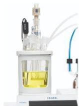
滴定液の消費と時間の節約に役立ちます。また滴定セルに入る周囲湿度の影響を考慮し計算を自動調整。より正確な結果が得られます。
