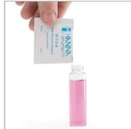
ガラスセルを取り出し、その水に試薬を加えます。
