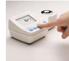
測定部にサンプルを2滴垂らしボタンを押すと約1.5秒で糖度(% Brix)を表示。どなたでも簡単に測定できます！
