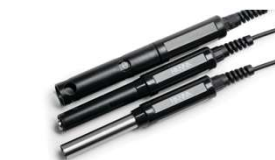
電極を替えればECとDO測定も可能です。
