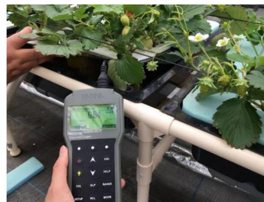
溶存酸素は生育効果を高める酸素濃度を知るために役立ちます。従来の隔膜式に比べ、蛍光式では「測定の安定性アップ」「メンテナンスの手間が半減」などのメリットがあります。50ppmまで測定できるため、酸素濃度を上げる場合にも対応できます。
