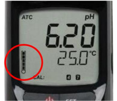
校正後12時間はpH電極の状態を画面左側に表示。本来目に見えないpH電極の状態を把握しメンテナンス/交換時期を適切に判断できます。
