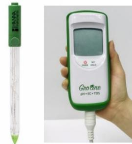
別売りのpH電極を使えば養液だけでなく土壌や固形培地のpHをダイレクトに測定できます！
