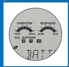
pH校正後はその日中、電極の 状態と反応速度を画面表示。 ゲージはpH電極のオフセット/ スロープ特性に基づいていま す。これによりpH電極の状態 を把握し電極のメンテナンスや 交換時期の判断に役立ちます。
