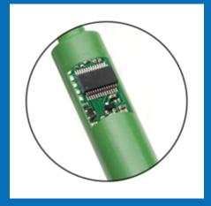
マイクロチップを内蔵したスマート電極を採用。本体に接続すると直近の校正情報を自動認識します。このため電極を接続するたびに校正しなければいけない、ということはありません。
