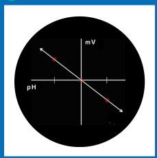
任意の校正ポイントを選べるのがカスタム校正です。測定試料のpH値に近いところで校正することで精度、信頼性、反応速度が高められます。ハンナではpH1~13の全18種類の標準液からカスタム校正を行えます。(5点校正まで可能)
