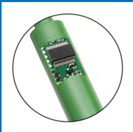
マイクロチップを内蔵したスマート電極を採用。本体に接続すると直近の校正情報を自動認識します。このため電極を接続するたびに校正しなくても構いません。
