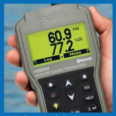
隔膜式と比べ流速がなくても 安定した測定が可能。メンブ ランや電解液は使わないため メンテナンスも簡単。基本的 には電極先端部のスマートキ ャップを1年に1度交換するだ けです。
