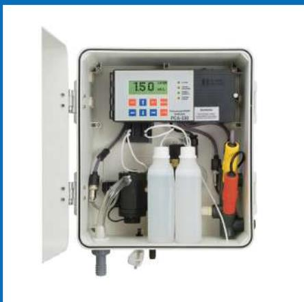
残留塩素、pH、ORPを常時モニター。残留塩素の測定周期は3分～90分まで設定が可能。設定値を下回ると、塩素投与リレーが作動、上回ると停止します。
