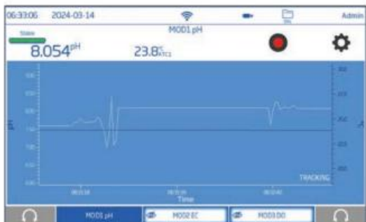
グラフ表示 測定したデータの推移をグラフで確認でき Wi-FiやUSB接続によりデータ転送も可能。
