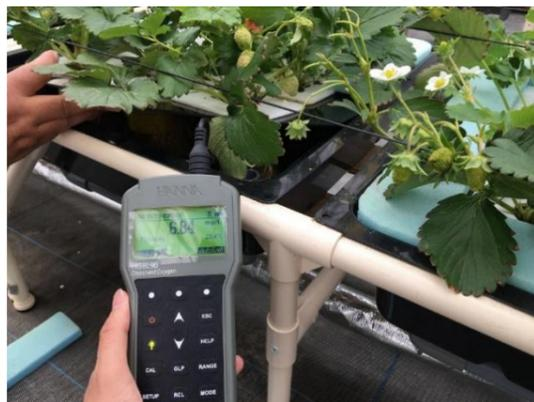
溶存酸素は生育効果を高める酸素濃度を知るために役立ちます。従来の隔膜式に比べ、蛍光式では「測定の安定性アップ」「メンテナンスの手間が半減」などのメリットがあります。50ppmまで測定できるため、酸素濃度を上げる場合にも対応できます。
