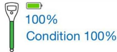
目には見えないpH電極の状態が%で見えるため、電極のメンテナンス/交換時期の判断にも役立ちます。
