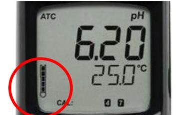
校正後12時間はpH電極の状態を画面左側に表示。本来目に見えないpH電極の状態を把握しメンテナンス/交換時期を適切に判断できます。
