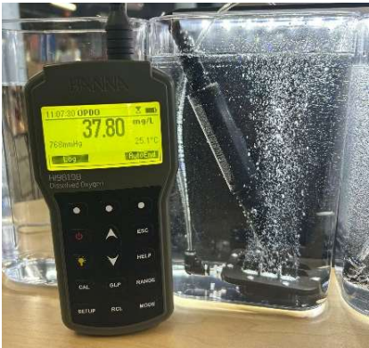
50mg/Lの高濃度域まで測定できます。 また、微細な気泡発生装置を利用する 際に高い酸素濃度を維持できているか のチェックでも活躍しています。
