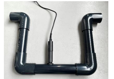
※センサー部は養液の流れが滞りしないよう設置
