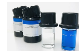
バリデーター(標準液)の外観例 測定値の検証と校正が可能。 本体の精度や信頼性を確認できます。
