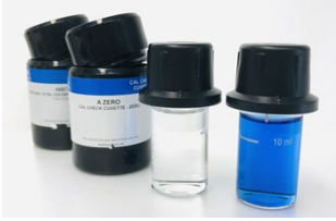
バリデーター(標準液)の外観例 測定値の検証と校正が可能。 本体の精度や信頼性を確認できます。
