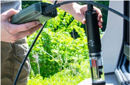
専用の標準液でpH/EC/DOの校正を一度に行えとっても便利
